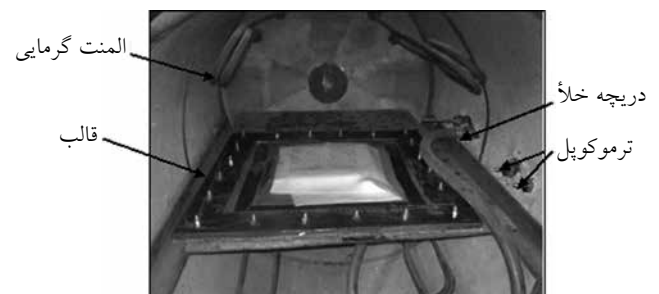
شکل ۱- نحوه قرارگیری قالب درون اتوکلاو.
